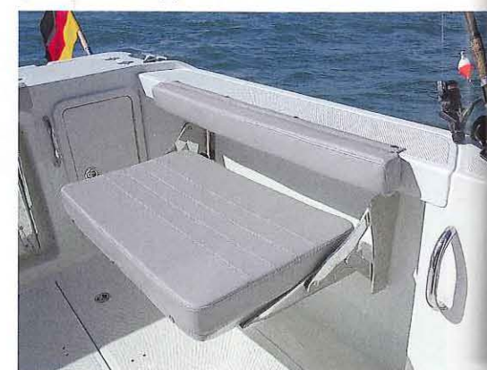
...Cockpit der Quicksilver sind mit einem ausgeklügelten Klappmechanismus versehen
