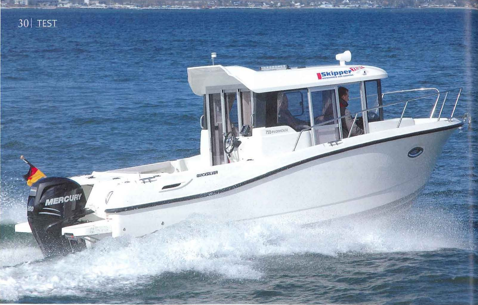
Mit dem vierzylindrigen Mercury F200 ist die Quicksilver Captur 755 Pilothouse sehr gut motorisiert. Das wetterfeste Boot geht 30,4 kn
