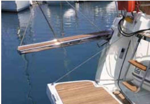
Retractable hydraulic passerelle / Passerelle hydraulique rétractable
