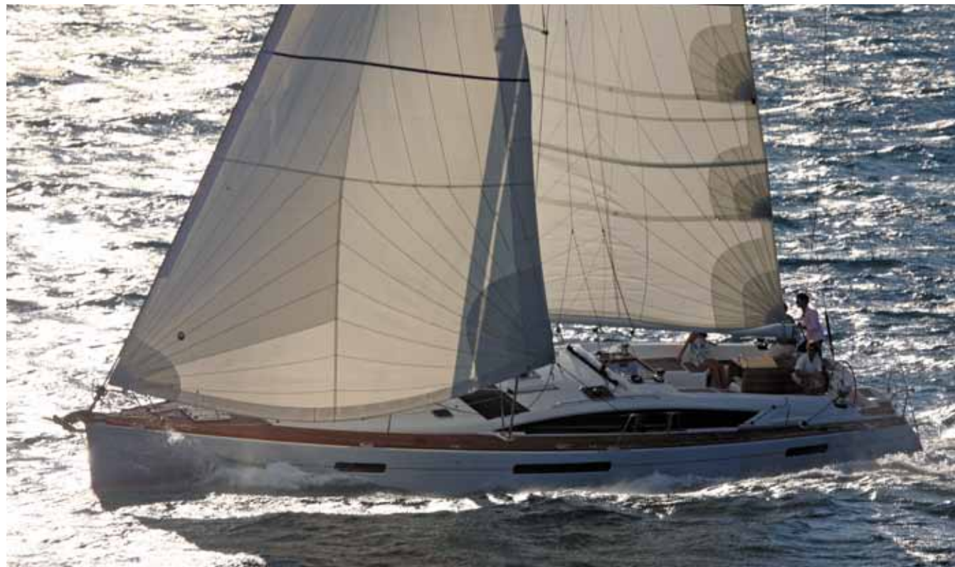
Performance rigging with white-painted mast and Mylar Taffeta sails / Gréement Performance avec mât laqué blanc et voiles en Mylar Taffetas
